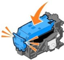
9. Levante a unidade de impressão e segure o suporte do scanner para cima enquanto abaixa a unidade, até fechá-la completamente.
